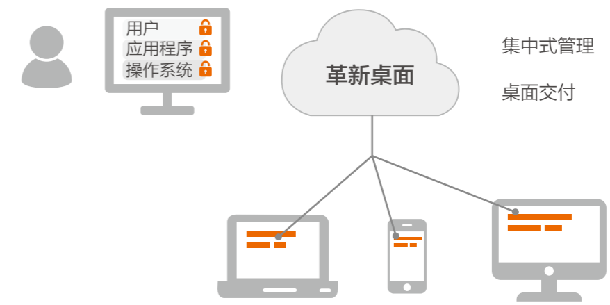
附图二 虚拟化桌面体系架构
