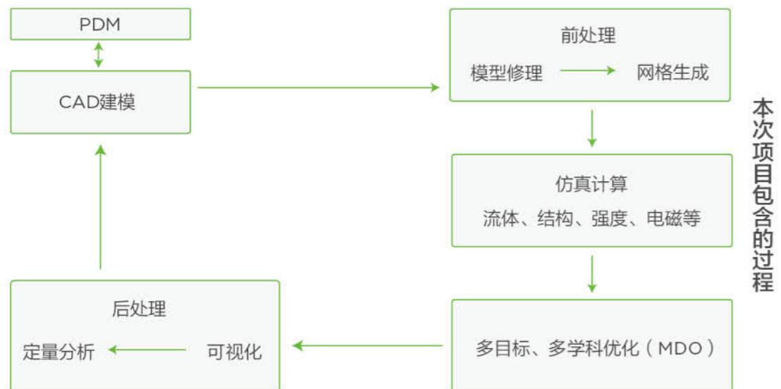
前处理主要用于对工程或产品进行建模，建立合理的有限元分析模型（包括建立问题的几何模型、进行网格划分、建立用于计算分析的数值模型、确定模型的边界条件和初始条件等）。
